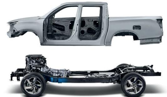
El vehículo Musso y Musso Grand se diferencia de otros fabricantes de pick-up porque utiliza un nuevo bastidor cuádruple en lugar de la estructura monocasco tradicional. Este bastidor está hecho de acero de ultra alta resistencia, lo que lo hace muy fuerte y capaz de absorber los impactos de la carretera en terrenos difíciles. Esto garantiza una rigidez y estabilidad óptimas al conducir en condiciones adversas.
