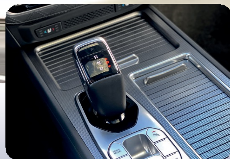
4x4 con bajo transmisión electrónica Shift By Wire con 8 velocidades
